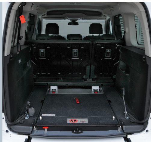
Mit der eingeklappten EASYFLEX Rampe kann der Kofferraum voll genutzt werden.
